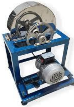
Gambar 2.3. Mesin Perajang Singkong dan Pisang Dengan Penggerak Motor
