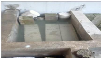
Gambar.4.8. Perendaman Benda Uji Beton Tulangan Besi
