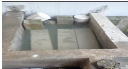
Gambar.4.9. Perendaman Benda Uji Beton Tulangan Besi
