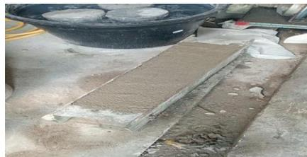
Gambar.4.5. Pengecoran Sampel Tulangan Bambu
