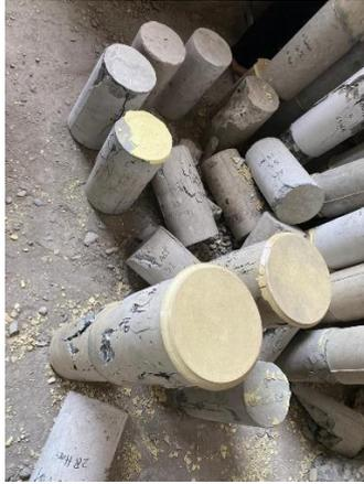
Gambar L. 13 Retakan Pada Benton
