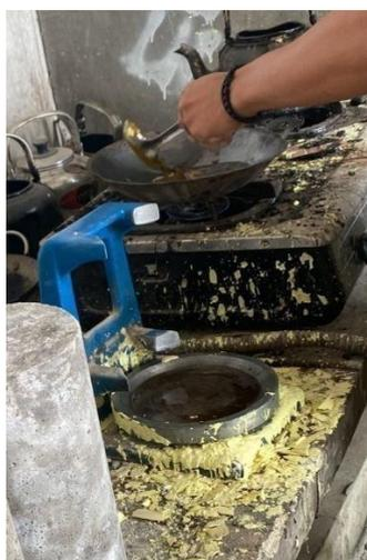
Gambar L. 9 Pemasangan Capping Pada Benda Uji
