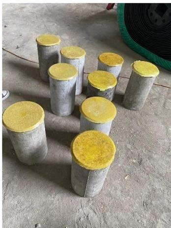
Gambar L. 10 Benda Uji Yang Sudah diCapping
