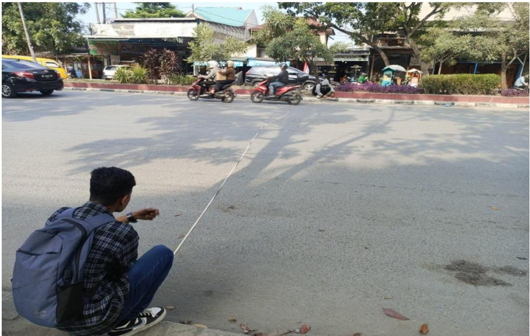
Gambar L.2 : Pengukuran Lebar Jalan
