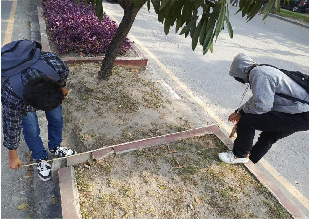
Gambar L.3: Pengukuran lebar Median
