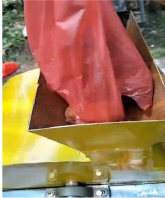
Gambar 4.26 Memasukkan Buah Pala Untuk Di Uji Beban Pada Ripple Mill
