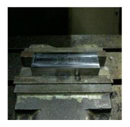
Gambar 4.4. Bahan benda kerja baja AISI 4340
