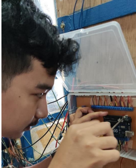
Gambar 4.6 Pemasangan Arduino Uno ke Papan PCB
