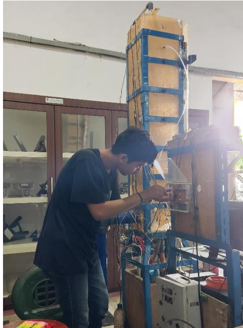
Gambar 4.8 Pemasangan Rangkaian Instrument Pada Wet Cooling Tower
