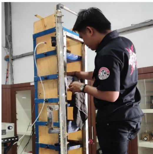
Gambar 4.9 Pemasangan Sensor DS18B20 Pada Wet Cooling Tower
