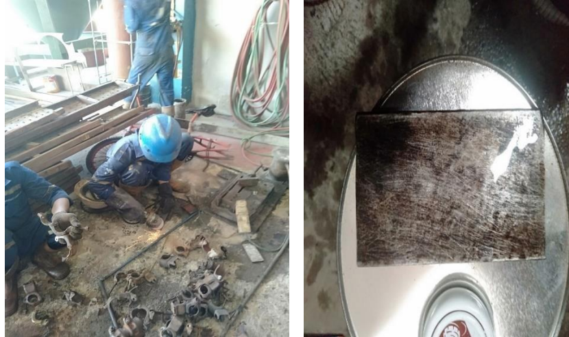
Gambar 4.2 Proses Meratakan Permukaan Specimen
