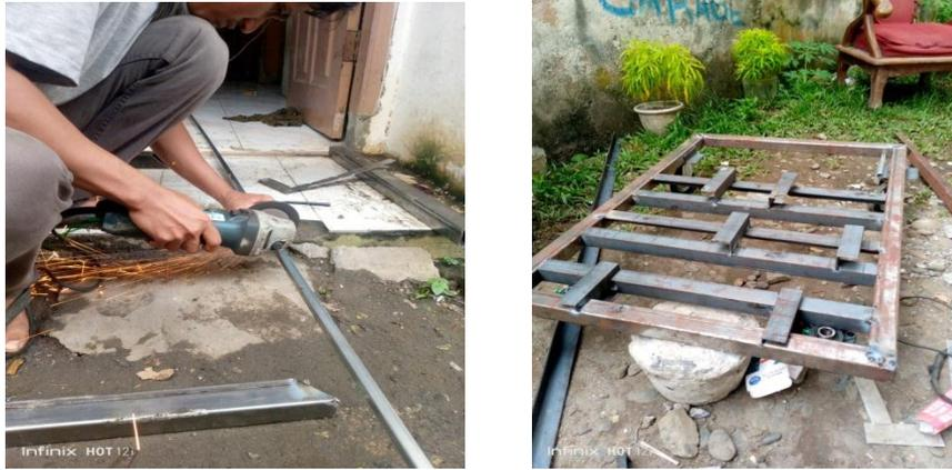
Gambar 4.1 Pembuatan Rangka
