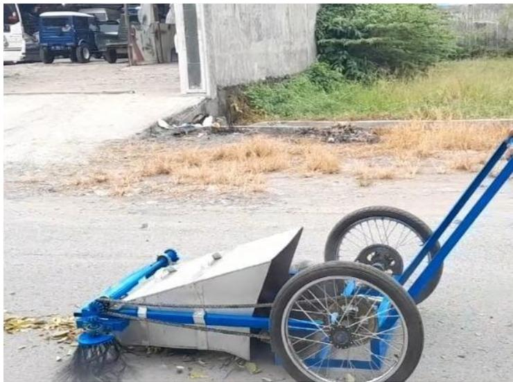
Gambar 2.2 Mesin penyapu jalan mekanik
