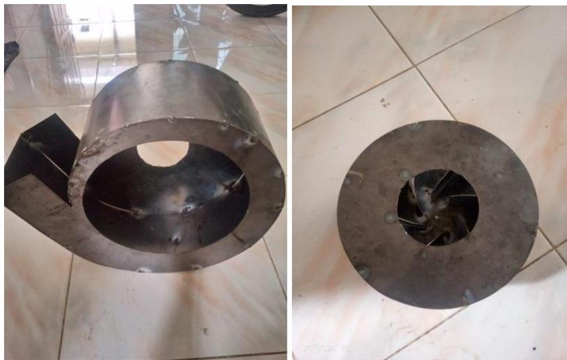
Gambar 4.4 Pembuatan Kipas Dan Body Blower Sentrifugal
