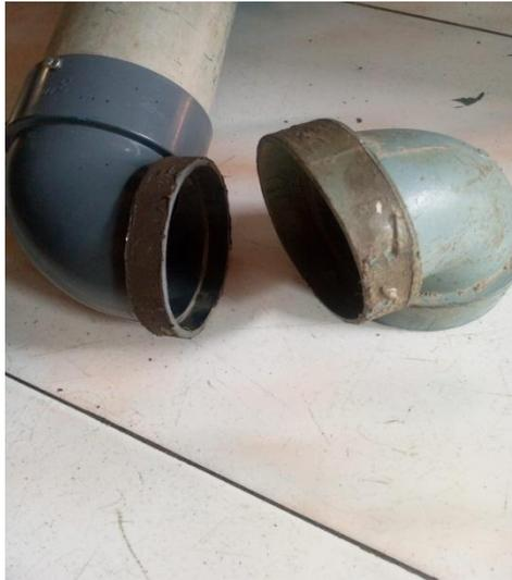
Gambar 3.15 sambungan pipa L
