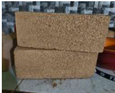
Gambar 4.15 : Proses perendaman batu bata
