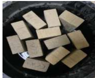
Gambar 4.15 : Proses perendaman batu bata
