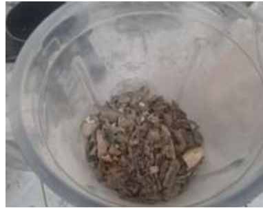
Gambar 3.20 : Proses Pembelenderan Kulit singkong Menjadi (AKS)
