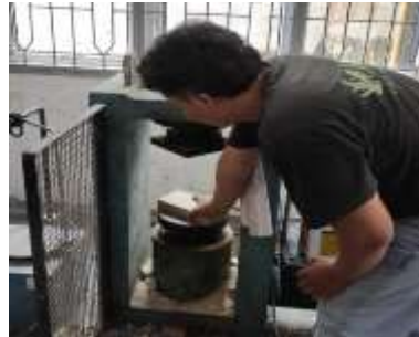
Gambar 4.6 : Proses pengujian kuat tekan batu bata
