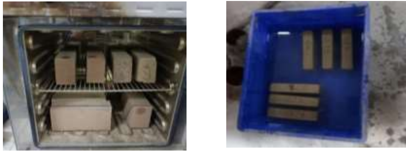
Gambar 4.12 : Proses pengovenan dan perendaman bata
