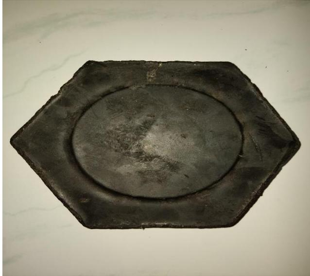
Gambar 4.21 *Paving Block* komposisi 50% : 50%
