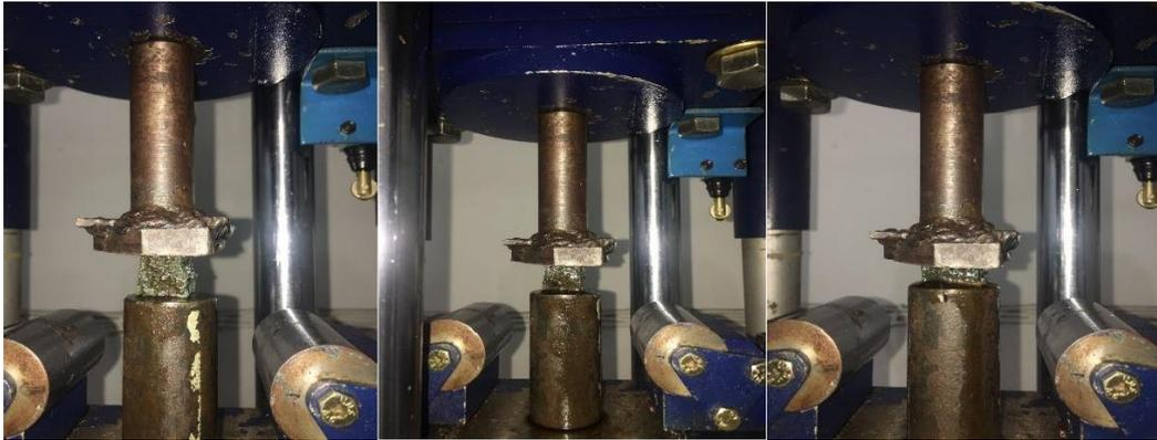
Gambar 4.5 Pengujian spesimen *Paving Block*
