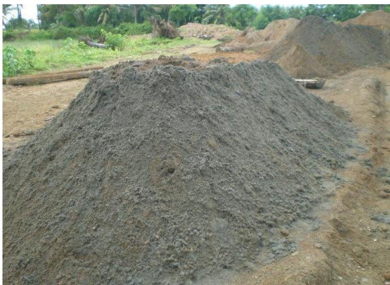
Gambar 2.4 Pasir Beton
