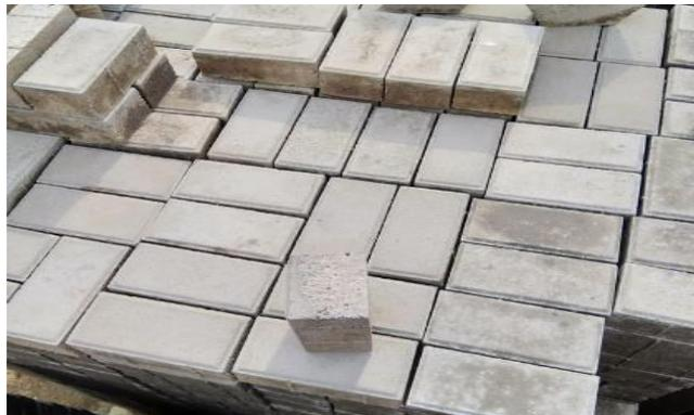
Gambar 2.7 *Paving Block* persegi panjang
