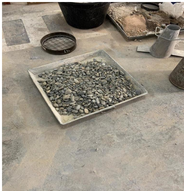
Gambar L. 6: Pencucian agregat dari lumpur dan kotoran
