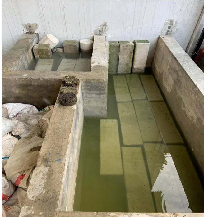
Gambar L. 13: Perendaman sampel beton
