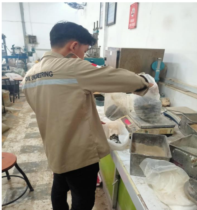
Gambar L. 7: Penimbangan agregat sesuai takaran
