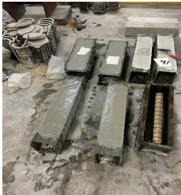
Gambar L. 12: Pencetakan sampel beton
