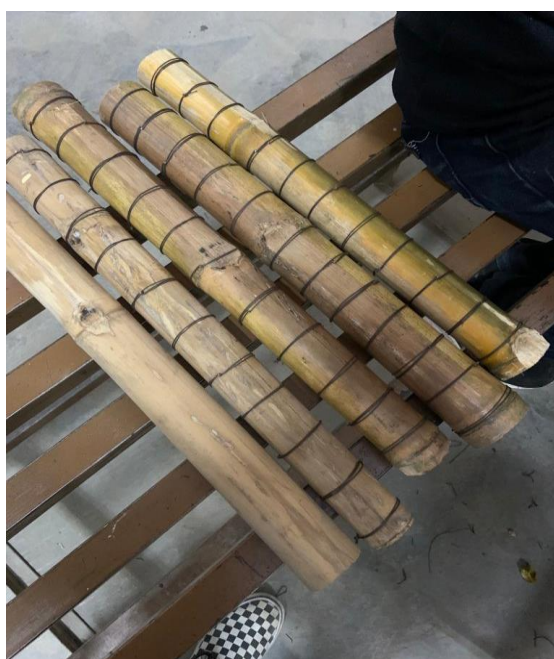
Gambar L. 10: Modifikasi kekasaran permukaan bambu dengan kawat
