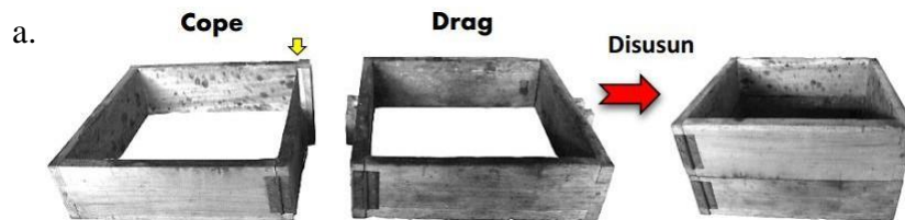
Gambar 2.2. Rangka Cetak persegi dari kayu (Fuad arif, 2018)
