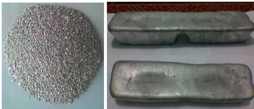
Gambar 2.5 Aluminium Butir dan Aluminium Padat (Surdia, 1992)
