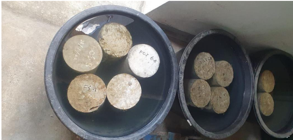
Gambar 3.4: Proses perendaman benda uji terhadap larutan Magnesium Sulfat.
