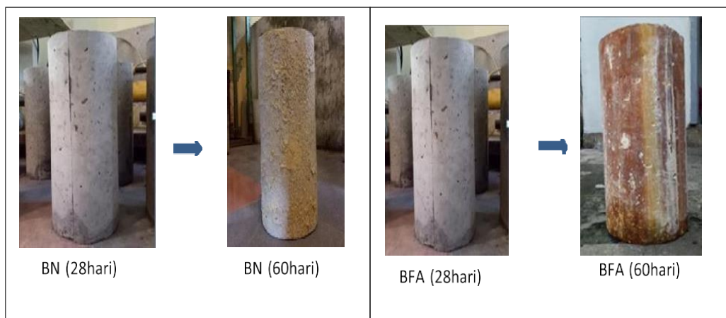
Gambar 2.4: kondisi beton setelah direndam 28 sampai 60 hari (Mufti dan Imran, 2020)
