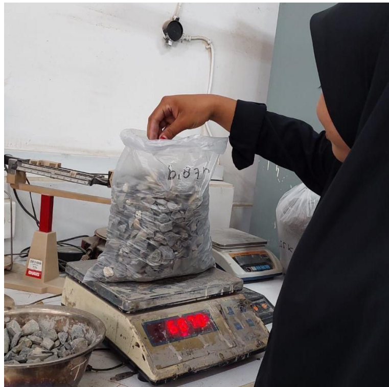
Gambar 7.8: Penimbangan agregat sesuai takaran.
