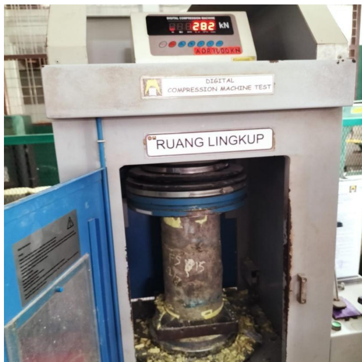
Gambar 7.14: Pengujian kuat tekan beton.
