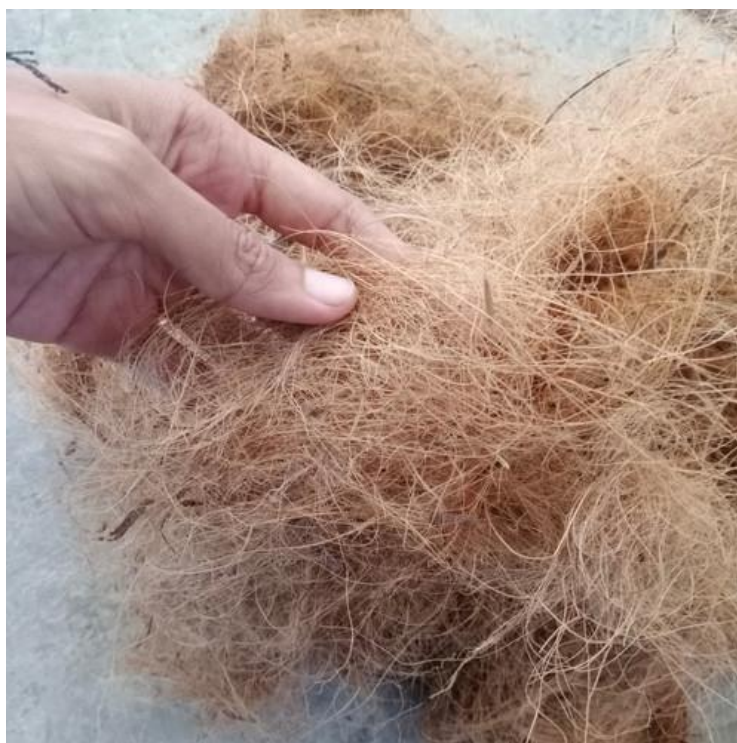
Gambar 7.2: Sabut kelapa sebagai serat pada campuran beton.
