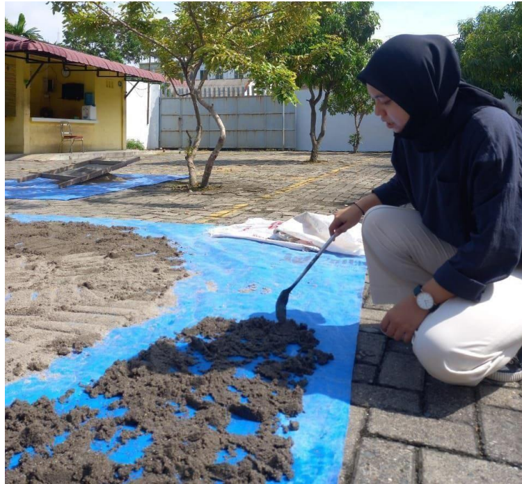
Gambar 7.3: Pengeringan agregat sampai kondisi SSD.
