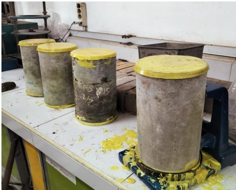
Gambar 7.12: Pemasangan capping pada benda uji.
