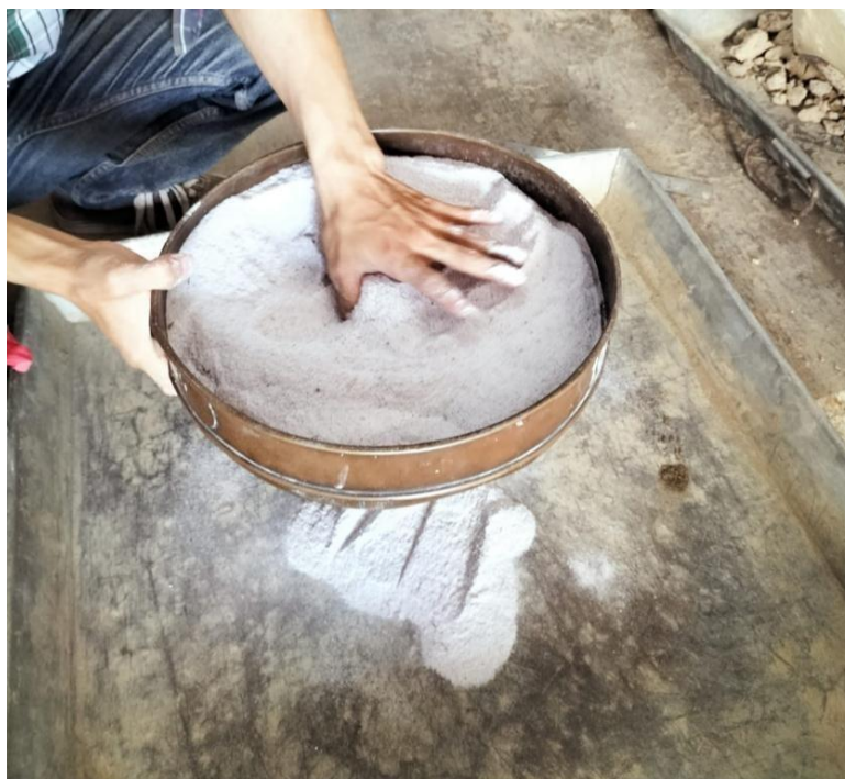
Gambar 7.1: Abu sekam padi lolos saringan No.100.
