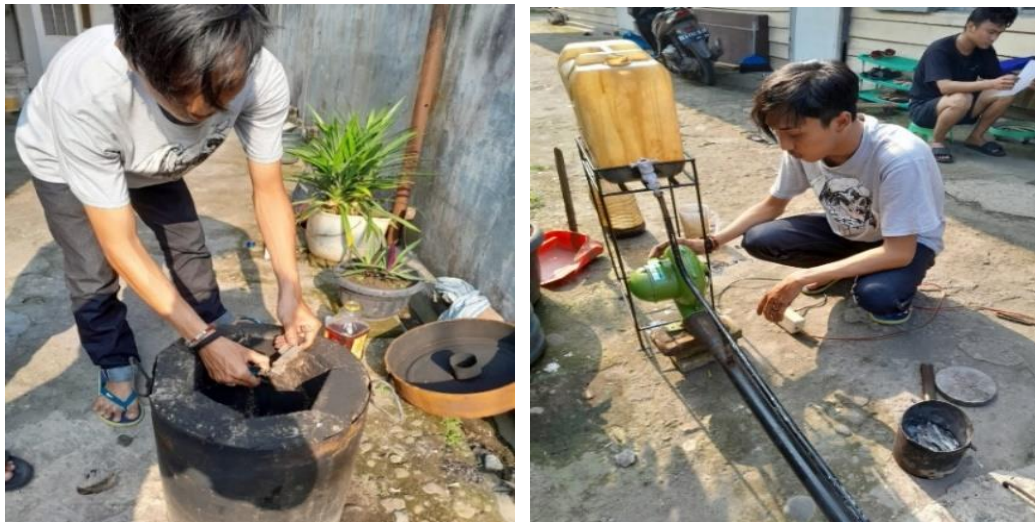
Gambar 4. 4 Penyalaan awal dengan menyiramkan kayu bekas dengan bensin
