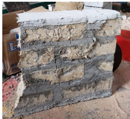
Gambar 4.18: Hasil pengujian kuat tekan pasangan bata (kapur)
