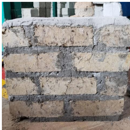
Gambar 4.17: Hasil pengujian kuat tekan pasangan bata (semen)
