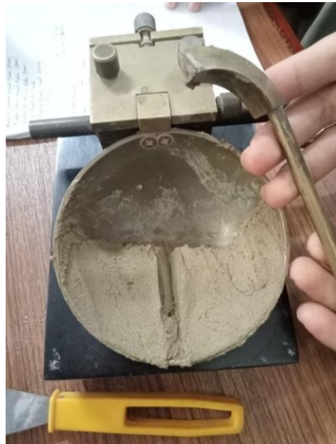
Gambar 4.3: Uji indeks plastisitas tanah galong
