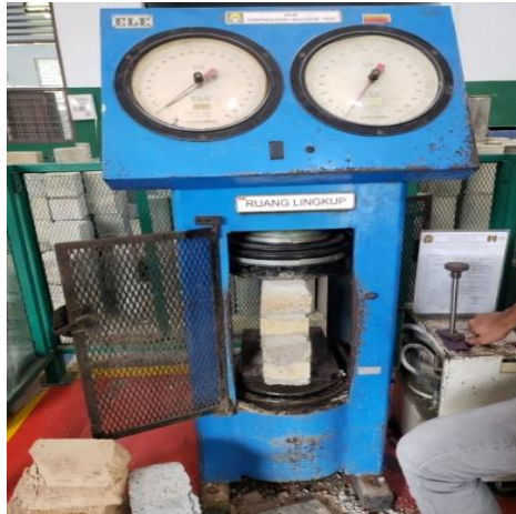
Gambar 4.16: Proses pengujian kuat tekan pasangan bata
