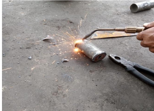
Gambar 4.11. Proses Pengelasan Tabung Kondensor
