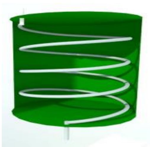
Gambar 2.7. Kondensor tipe spiral (Moh Arif Batutah, 2021).
