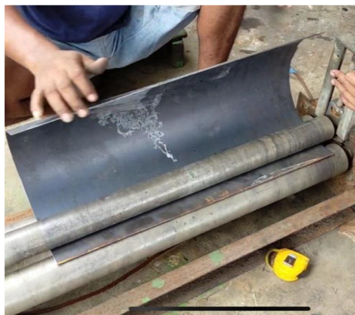
Gambar 4.10. Pembentuk tabung kondensor Menggunakan Mesin Roll manual
