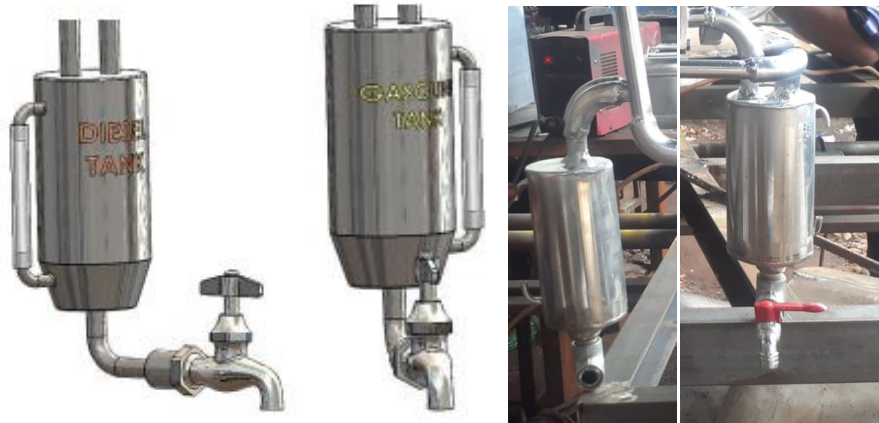
Gambar 4.4 Hasil Pembuatan Tabung Penyimpan Bahan Bakar
