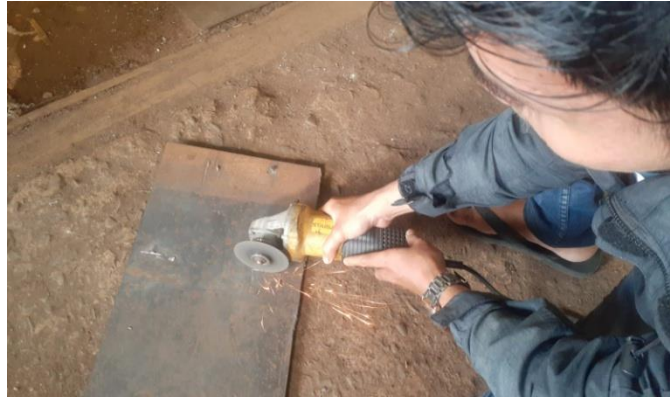
Gambar 4.9. Pemotongan Plat Untuk Tabung kondensor
