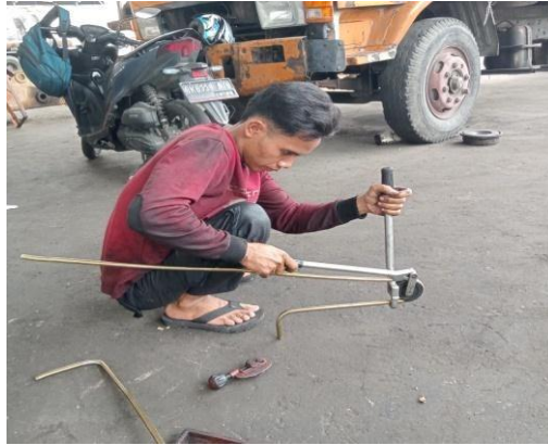
Gambar 4.13. Proses Pembengkokan pipa Penghubung
