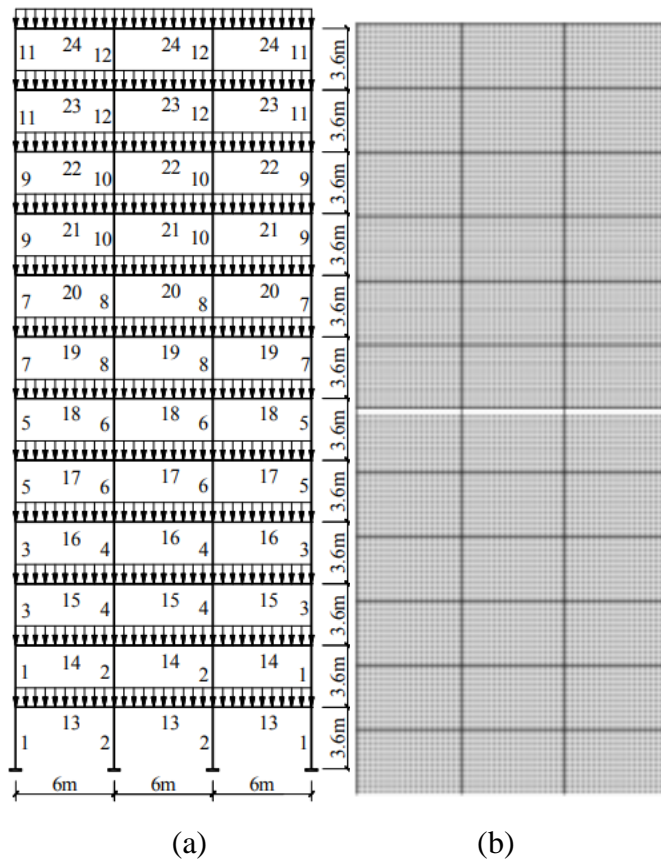
Gambar 4.13: Struktur baja 12 lantai (a) Struktur utama, (b) Struktur utama dengan desain domain (Huang dan Wang, 2011).
