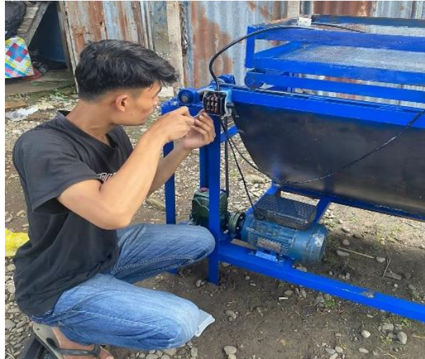
Gambar 4.35 Pemasangan cam starter
