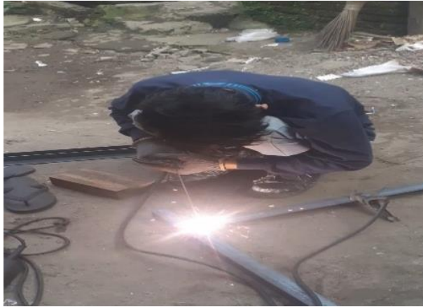
Gambar 4.4 Proses pengelasan rangka
