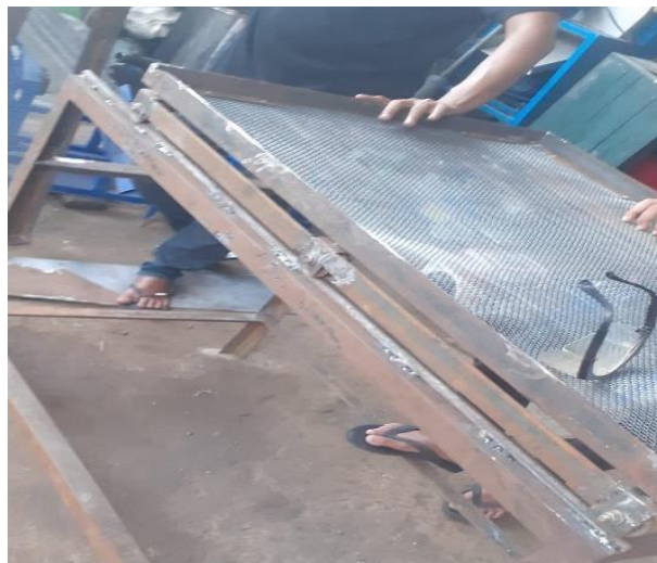
Gambar 4.34 Pemasangan rangka dan ayakan
