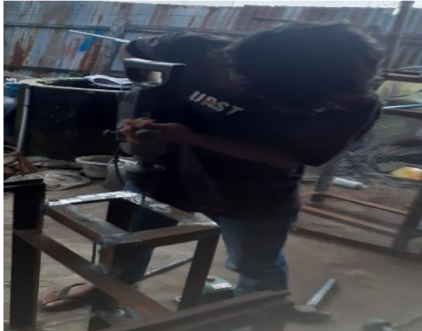
Gambar 4.6 Proses Pengeboran Lubang Pada Rangka
