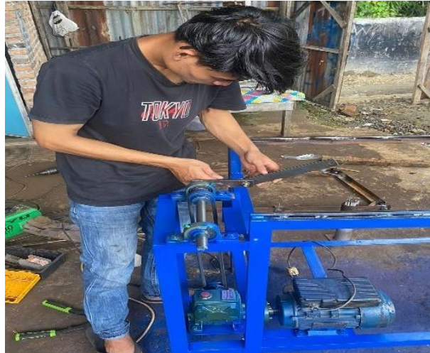
Gambar 4.33 Pemasangan lengan pendorong
