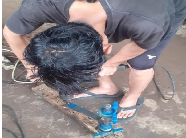
Gambar 4.22 Pengeboran lubang pada lengan pendorong
