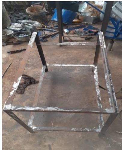
Gambar 4.4 Proses pengelasan rangka
