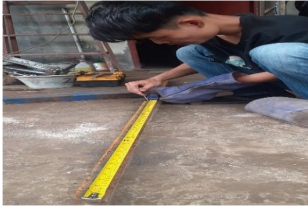
Gambar 4.2 Proses Pengukuran Besi Siku untuk rangka
