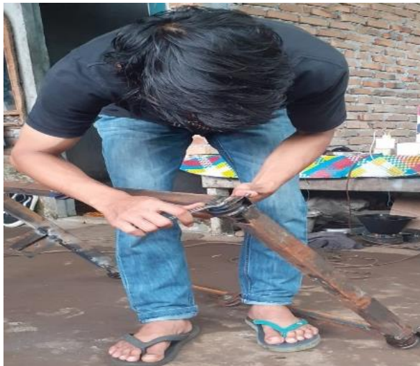
Gambar4.17 Proses pemasangan roda pada rangka ayakan
