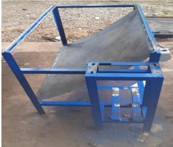
Gambar 4.8 Hasil Pengeboran lubang pada Rangka
