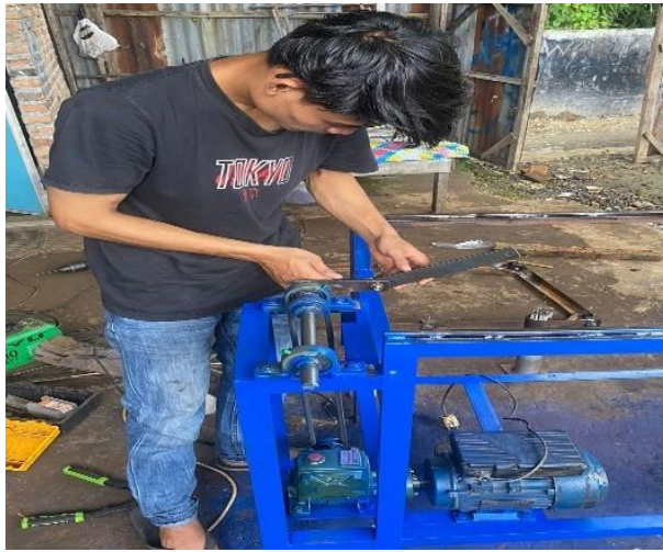
Gambar 4.24 Pemasangan lengan pendorong
