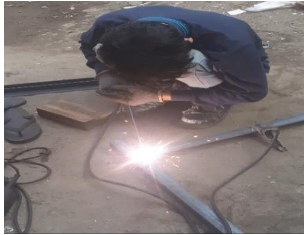
Gambar 4.10 Proses pengelasan Rangka Ayakan
