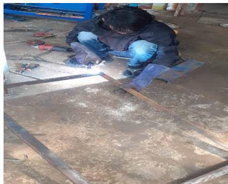
Gambar 4.15 Proses pengelasan rangka penopang ayakan
