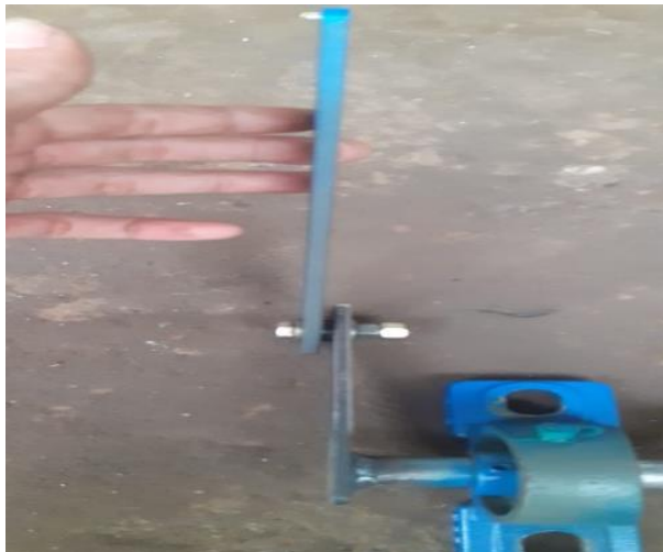
Gambar 4.23 Penyambungan lengan pendorong
