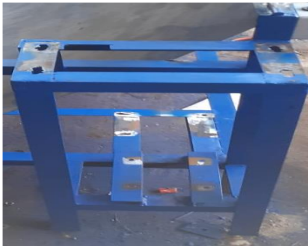
Gambar 4.7 Hasil Pengeboran Pada Rangka
