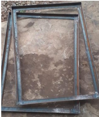
Gambar 4.11 Hasil Pengelasan Rangka Ayakan
