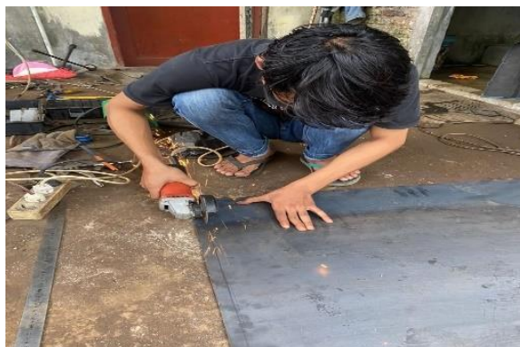
Gambar 4.21 Pemotongan plat hitam
