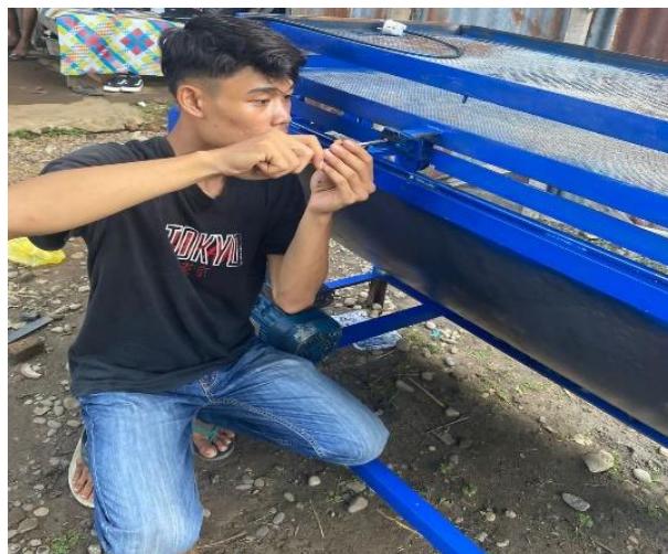
Gambar 4.36 Pemasangan limit switch
