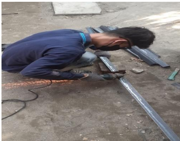
Gambar 4.9 Proses pemotongan besi siku untuk ayakan
