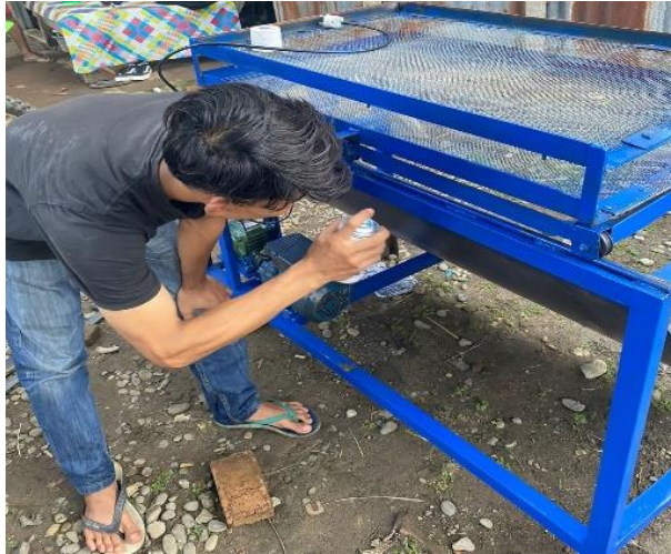
Gambar 4.37 Pengecatan seluruh rangka
