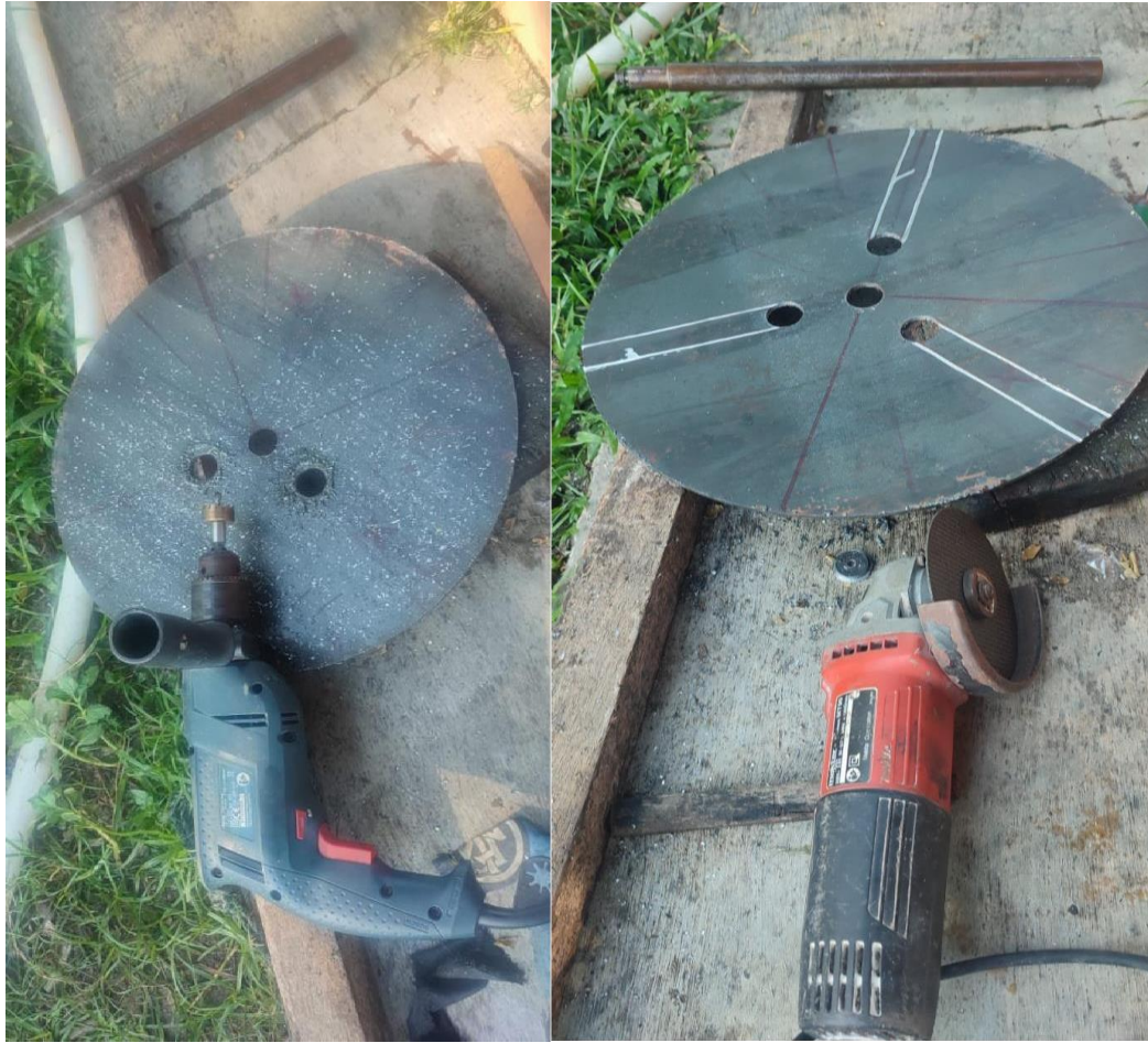
Gambar 4.2.3.1 Hasil pemotongan dan pengeboran plat piringan dudukan poros dan mata pisau mesin pencacah
