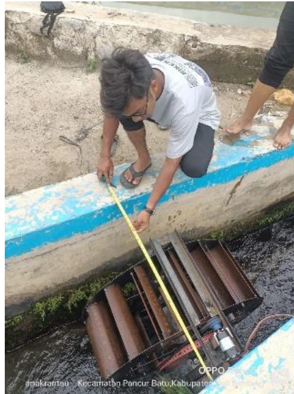
Gambar 4.5 Mengukur Lebar Aliran Air
