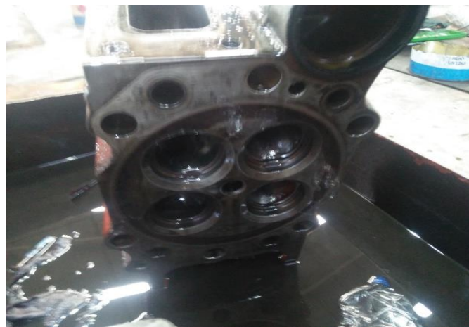
Gambar 4.9 Sebelum dilakukan pembersihan ( cleaning ) pada Cylinder Head
