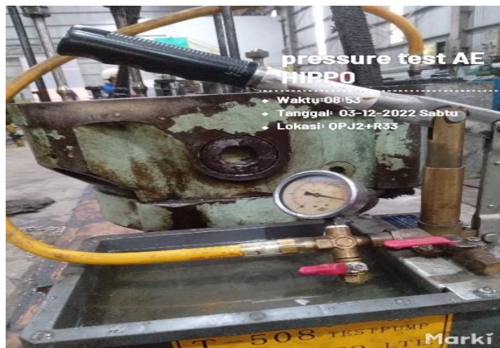
Gambar 4.13 Pengujian menggunakan Test Press
