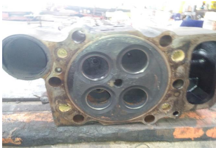
Gambar 4.7 keretakan pada Cylinder Head
