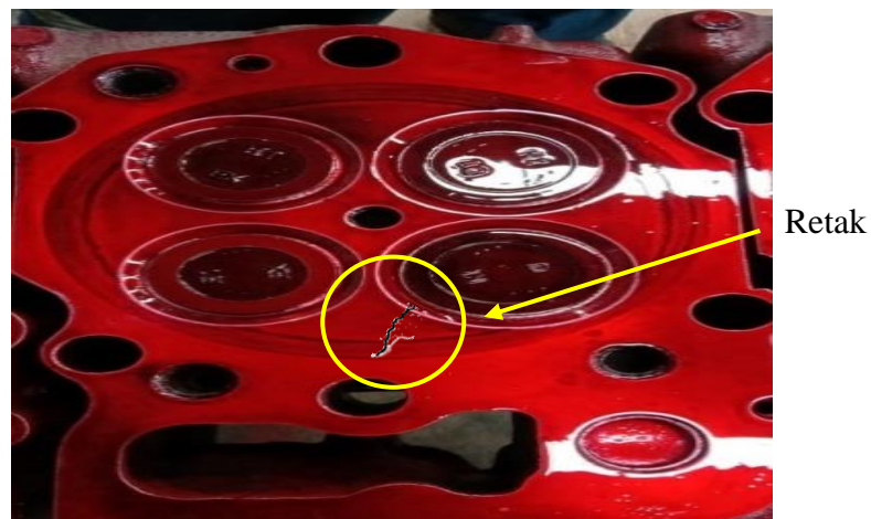
Gambar 4.11 Pengujian dengan Colour Check tahap 1
