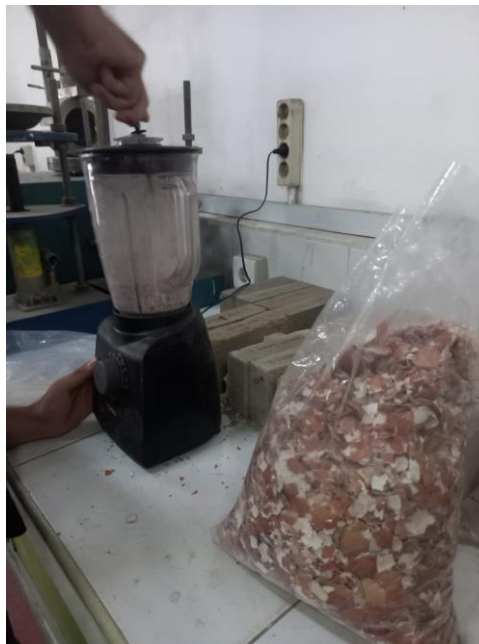
Gambar L.4 : Proses menghaluskan serbuk kulit telur
