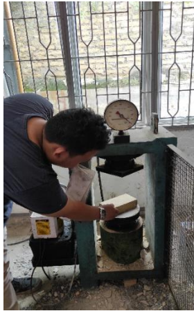
Gambar 4.8: Proses pengujian kuat tekan batu bata.
