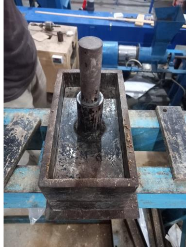
Gambar L.7 : Proses pencetakan bata
