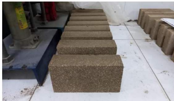
Gambar 4.23: Benda uji daya tampak bata untuk tanah merah.
