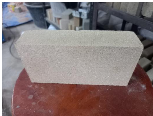
Gambar L.9 : Batu bata tanah galong dengan campuran serbuk kulit telur
