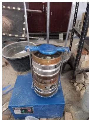
Gambar 4.5: Pengujian analisa butiran tanah galong dan tanah merah.
