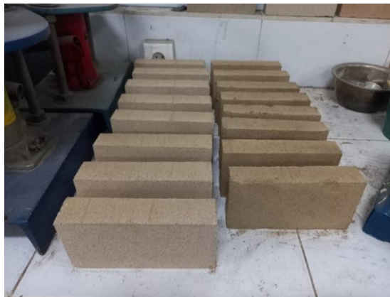
Gambar 4.22: Benda uji sifat tampak bata untuk tanah galong.
