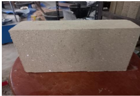
Gambar L.8 : Batu bata tanah merah dengan campuran serbuk kulit telur
