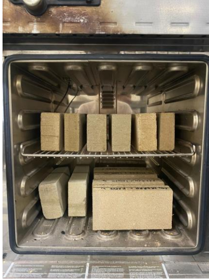
Gambar 4.14: Proses awal bata saat di oven.
