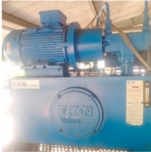
Gambar 2. 53 Hidrolik power unit
