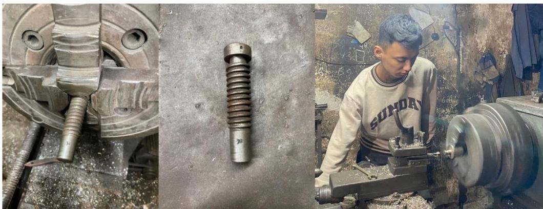
Gambar 4.12 Tahap Proses Pembuatan Batang Ulir
