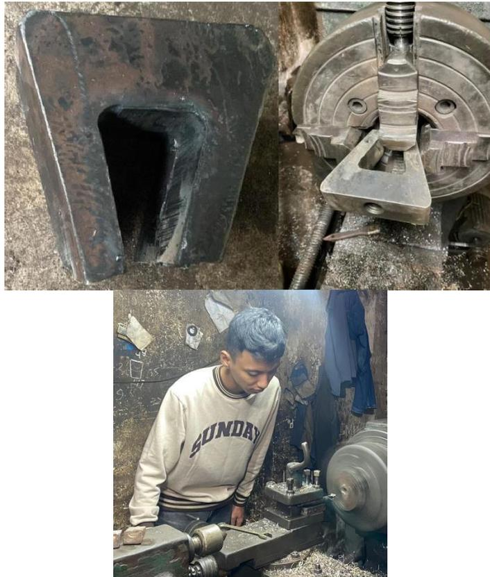
Gambar 4.10 Tahap Proses Pembuatan Cekam
