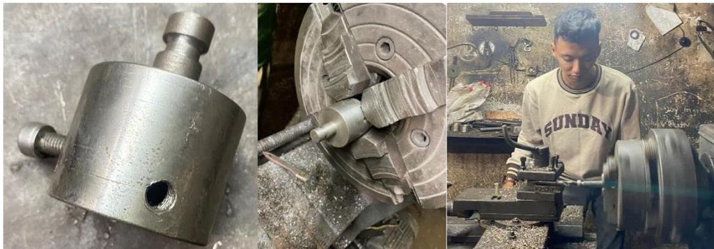
Gambar 4.14 Tahap Proses Pembuatan *Base*
