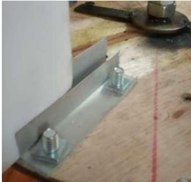
Gambar 4.12 Sudu yang telah terpasang
