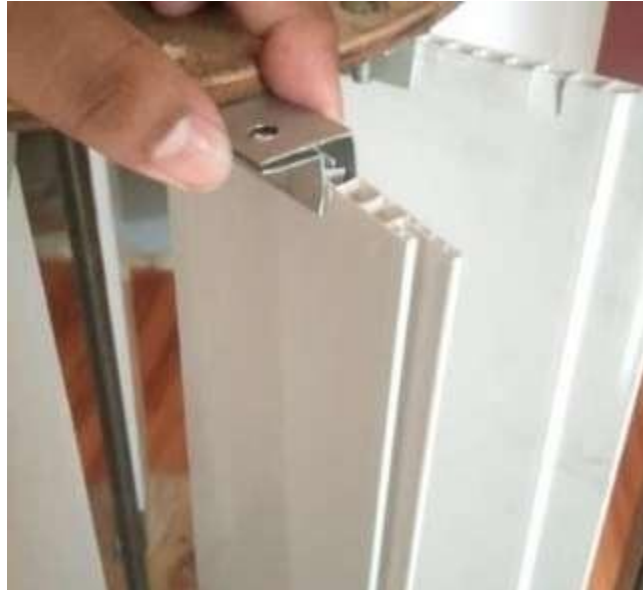
Gambar 4.10 Memasang Sudu – Sudu Turbin
