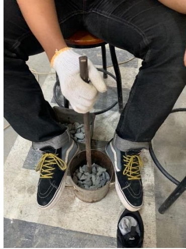
Gambar 3.7 : Pengujian berat isi dengan cara merojok
