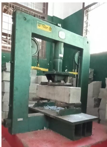
Gambar 3.14 : Penguian kuat lentur (Penguian laboratorium).
