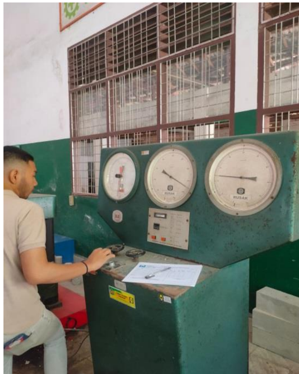
Gamba L.18 : Proses Pengujian Kuat Lentur
