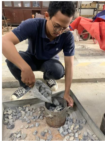
Gambar 3.8 : Pengujian berat isi dengan cara lepas
