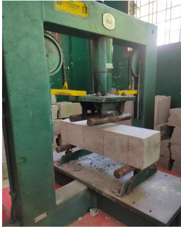
Gambar L.19 : Pengujian Kuat Lentur
