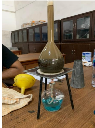
Gambar 3.4 : Pengujian berat jenis agregat halus, memanaskan piknometer.
