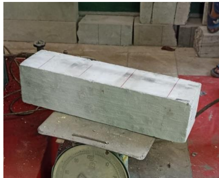
Gambar 2.5 : Benda uji balok beton 15 x 15 x 60 cm (Pengujian lab)
