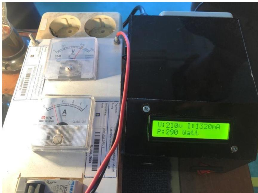
Gambar 4.2 Pengujian sensor arus
