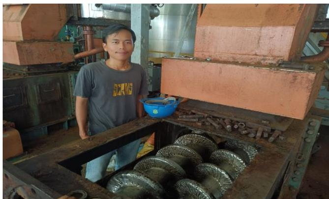
Gambar 4.12 Pemasangan Screw Press Bekas Yang Sudah Diperbaiki
