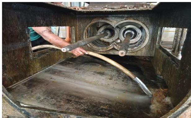
Gambar 4.10 Pemasangan Screw Press Bekas Yang Sudah Diperbaiki
