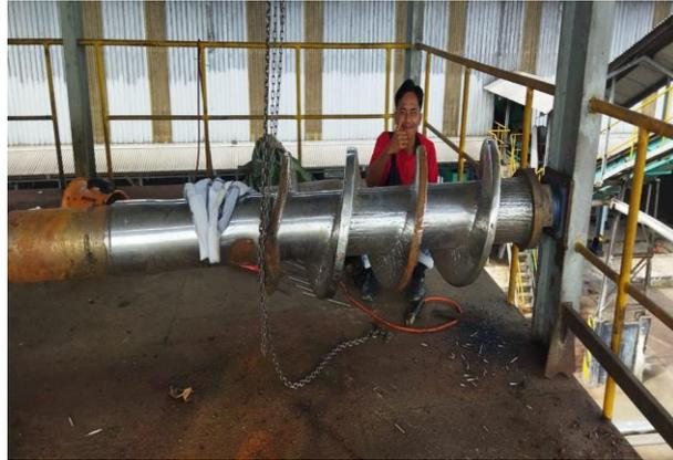
Gambar 4.3 Proses Mengamati Kerusakan Lain Pada *Screw Press*
