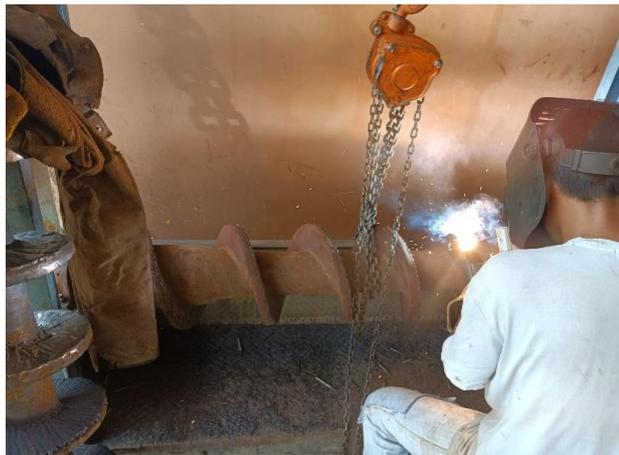
Gambar 4.6 Pengelasan di bagian puncak ulir screw press
