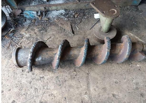
Gambar 4.7 *Rebuild Screw Press Tahap Kedua*
