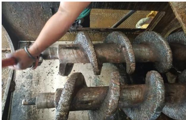
Gambar 4.11 Pemasangan Screw Press Bekas Yang Sudah Diperbaiki
