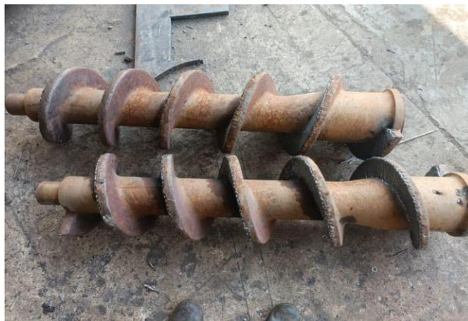
Gambar 4.8 Hasil Perbaikan *Screw Press*
