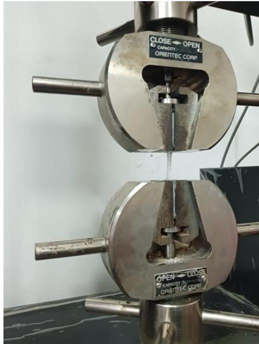
Gambar 2.15 Alat Uji Tensile
