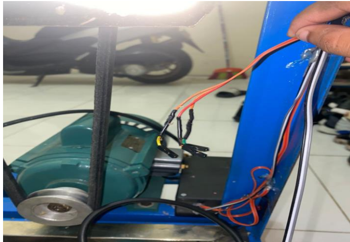
Gambar 4.16 peletakan kabel jumper ke rangka
