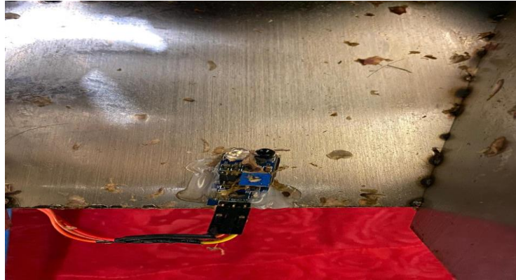
Gambar 4.14 peletakan sensor output bawah
