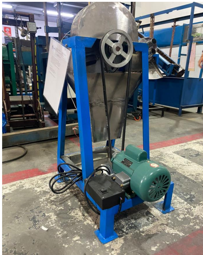
Gambar 4.17 Hasil perakitan perangkat Arduino Uno ke mesin pengiris bawang
