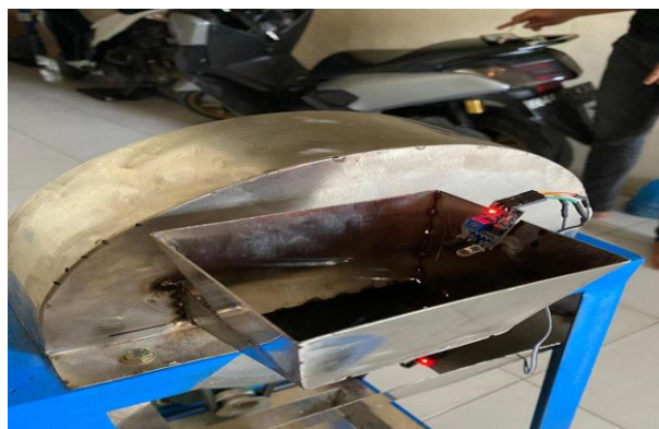
Gambar 4.13 Peletakan Sesnsor input
