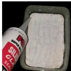
Gambar 4.3 Penuangan silen pada cetakan.
