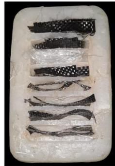
Gambar 4.26 Peletakan serat pada cetakan.
