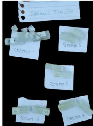
Gambar 4.39 Patahan spesimen 1.
