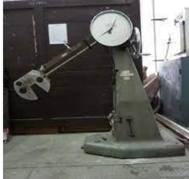
Gambar 3.13 Mesin uji impact.
