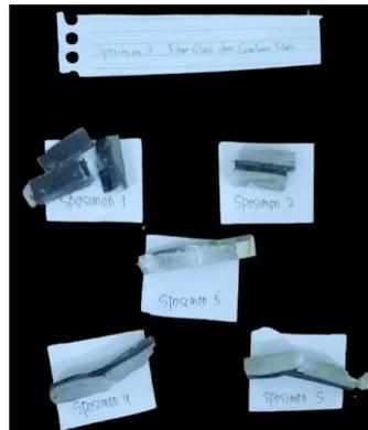
Gambar 4.41 Patahan spesimen 3.
