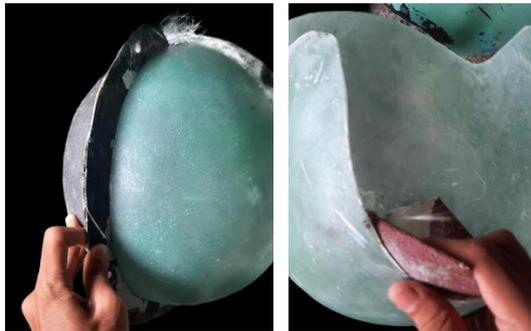
Gambar 4.53 Pelepasan cetakan dan pengamplasan fiber glass.
