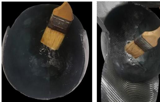
Gambar 4.54 Pengolesan resin eopxy dan meletakkan carbon fiber pada bagian dalam.
