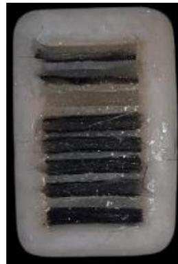
Gambar 4.33 Penuangan resin epoxy.
