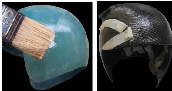
Gambar 4.57 Pengolesan resin epoxy pada bagian luar dan peletakan carbon fiber.
