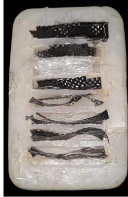
Gambar 4.32 Peletakan serat pada cetakan.
