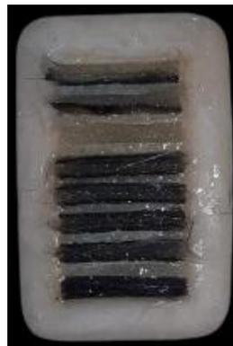
Gambar 4.27 Penuangan resin epoxy.
