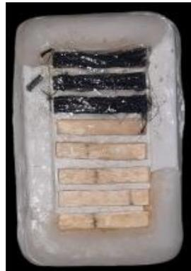
Gambar 4.15 Penuangan resin epoxy.
