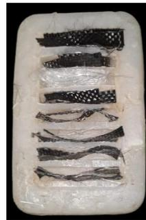
Gambar 4.8 Peletakan serat pada cetakan.
