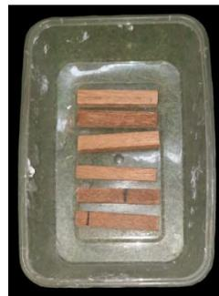
Gambar 4.2 Meletakkan kayu pada cetakan.
