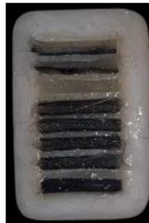
Gambar 4.9 Penuangan resin epoxy.
