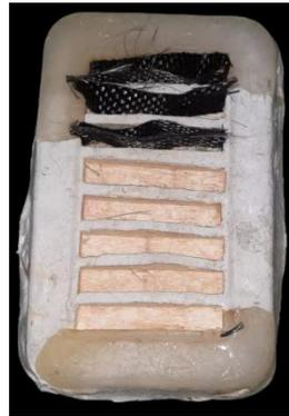
Gambar 4.14 Peletakan serat pada cetakan.
