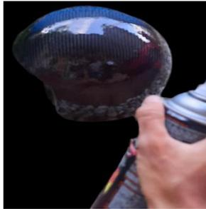
Gambar 4.61 Pelapisan clear coat.
