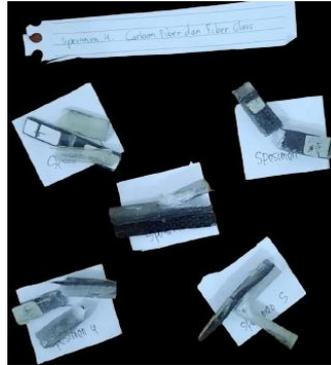
Gambar 4.42 Patahan spesimen 4.
