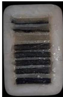
Gambar 4.21 Penuangan resin epoxy.
