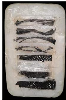
Gambar 4.20 Peletakan serat pada cetakan.
