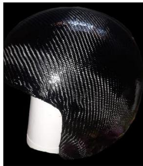
Gambar 4.59 Pengulangan pengolesan resin epoxy.
