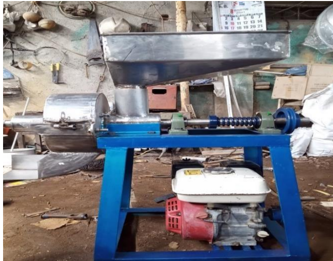
Gambar 2.5 Mesin Penggiling buah tomat kapasitas 5 kg/menit
