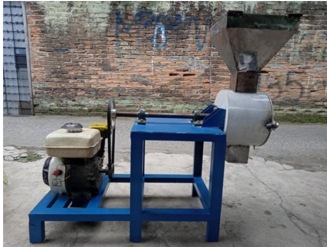
Gambar 4.66 Mesin penggiling biji durian kapasitas 18 Kg/ jam
