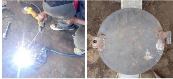
Gambar 4.31 proses pengelasan dan hasil dari pengelasan tutup ruang penggiling
