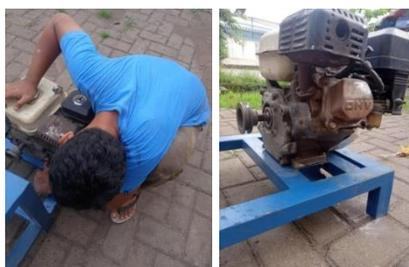
Gambar 4.63 Perakitan Motor bakar Pada Rangka
