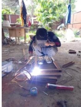
Gambar 4.5 Proses pengelasan rangka
