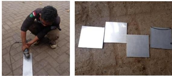
Gambar 4.58 Proses Pemotongan Dan Hasil Dari Pemotongan
