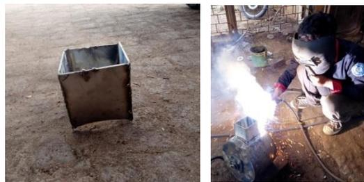
Gambar 4.59 Proses Pengelasan corong keluar
