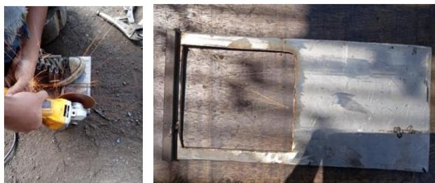
Gambar 4.55 Proses Pemotongan Plat Pembatas
