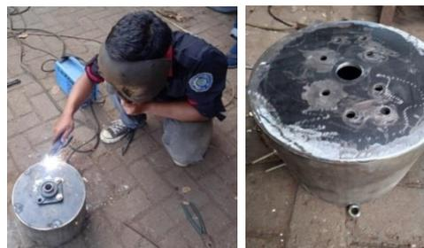
Gambar 4.23 Proses pengelasan tutup belakang dari ruang penggiling dan hasil dari pengelasan
