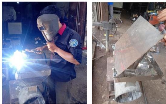
Gambar 4.52 Proses Pengelasan Tutup Hopper Dan Hasil Dari Pengelasan Tutup Hopper
