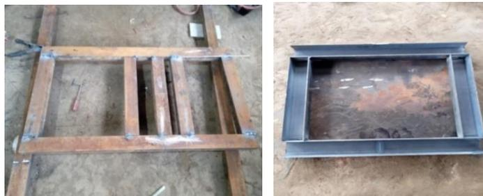
Gambar 4.6 Hasil pengelasan rangka atas dan bawah
