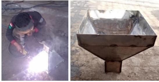
Gambar 4.46 Proses Pengelasan Hopper Dan Hasil Dari Pengelasan Hopper
