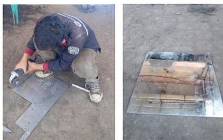
Gambar 4.49 Proses Pemotongan Plat Stainless Steel
