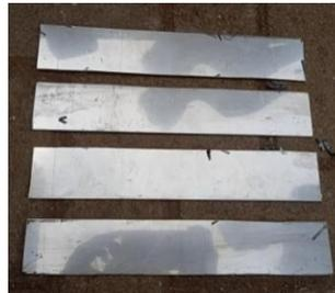
Gambar 4.44 Hasil Pemotongan Pembatas Hopper Atas
