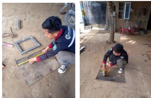
Gambar 4.4 Proses pengukuran dan pemotongan besi plat
