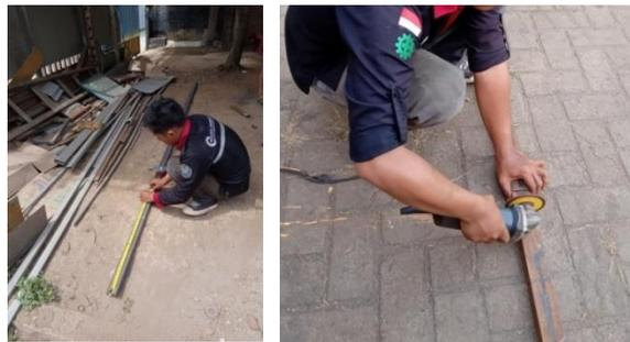
Gambar 4.3 Proses pengukuran dan pemotongan besi UNP
