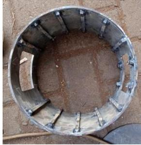
Gambar 4.21 Hasil dari pengelasan baja nako didalam ruang penggiling
