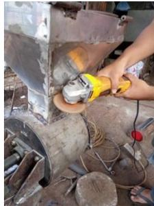
Gambar 4.54 Proses Penggerindaan Lubang Pembatas Hopper
