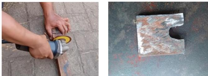
Gambar 4.28 Proses pemotongan plat pengunci dan hasil dari plat pengunci
