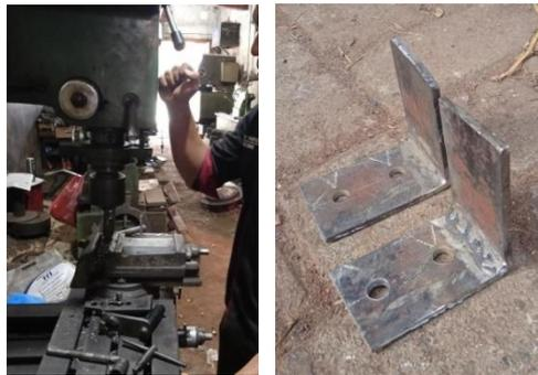
Gambar 4.14 proses pengeboran lubang baut untuk dudukan ruang penggiling
