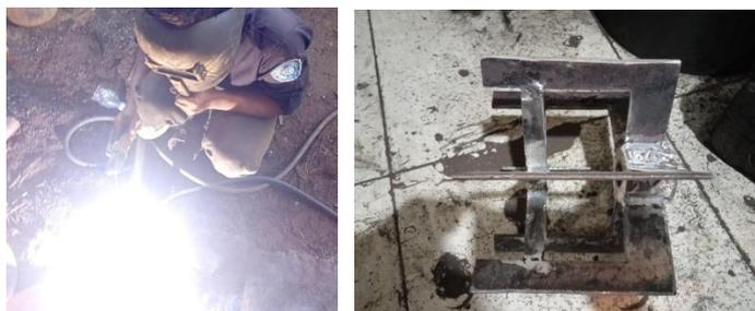
Gambar 4.41 Proses pengelasan dan hasil dari pengelasan
