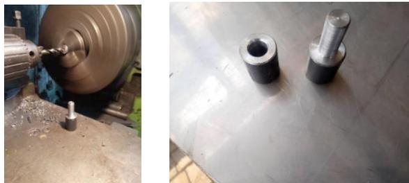
Gambar 4.30 proses pembubutan dan hasil dari pembubutan
