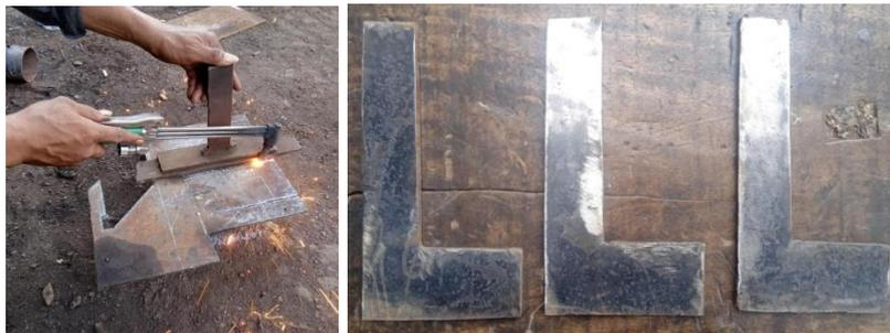
Gambar 4.40 Proses Pemotongan Plat Dan Hasil Dari Pemotongan Plat
