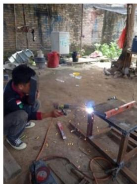
Gambar 4.7 Proses penyambungan rangka atas dan bawah dan pengelasan kaki rangka
