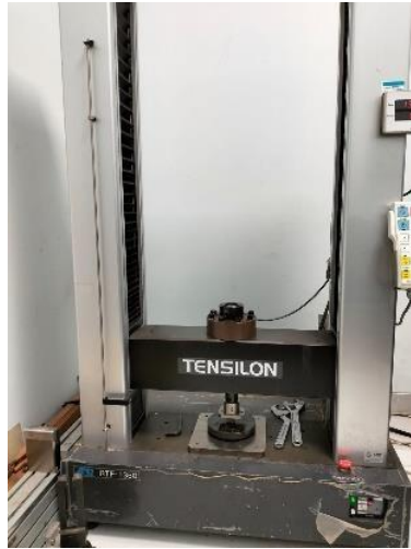
Gambar 3. 8 Mesin Uji Tekan
