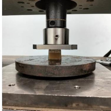
Gambar 4 22 Proses Pengujian Spesimen Uji Tekan
