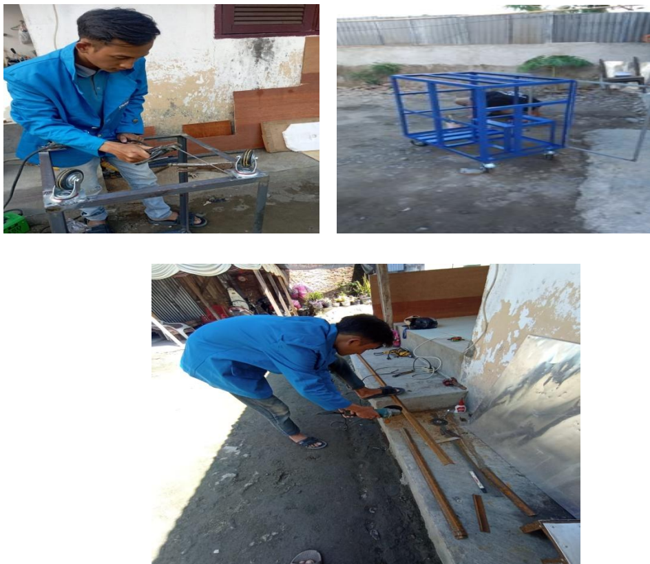
Gambar 4 . 1 Pembuatan Tebu Rangka Mesin Peras Tebu
