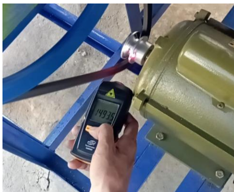
Gambar 4 . 3 Pengujian RPM menggunakan Tacho Meter
