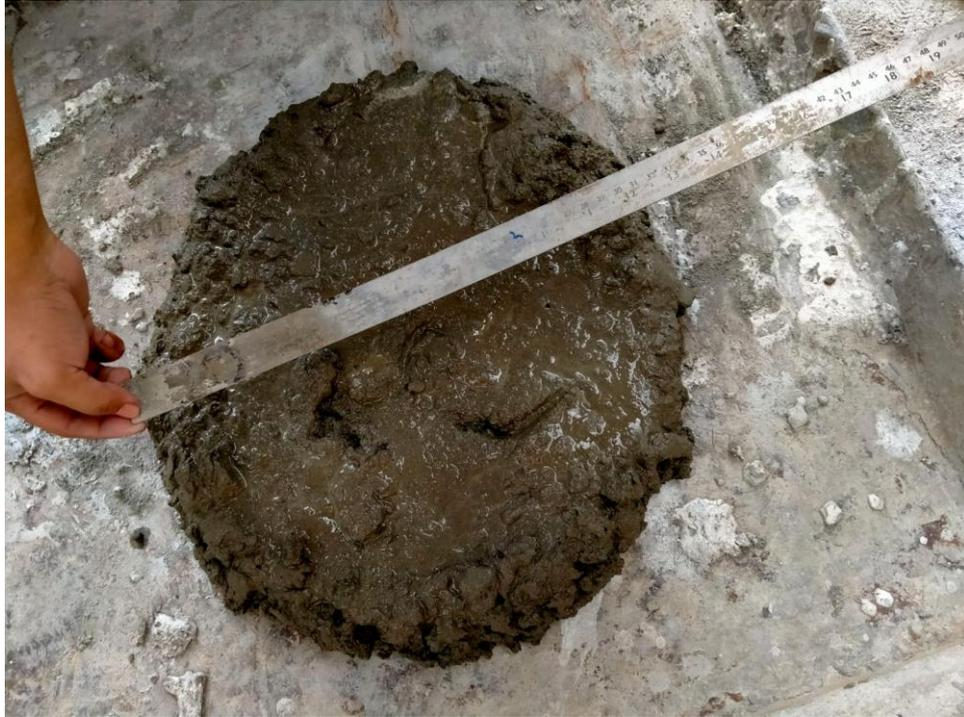
Gambar L.5: Melakukan pengujian *Slump Flow* pada beton segar
