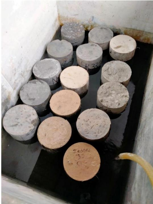
Gambar L. 10 Melakukan Perawatan Beton (*Curing*) dengan cara merendam beton
