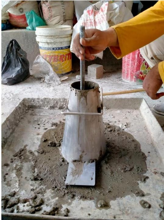
Gambar L. 3 Proses pemadatan beton dengan cara di rojok
