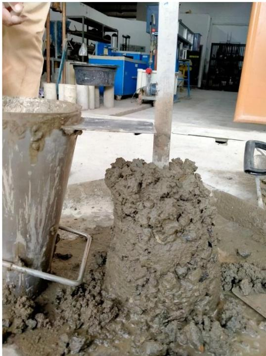
Gambar L. 4 Melakukan pengujian *Slump Test* pada beton segar
