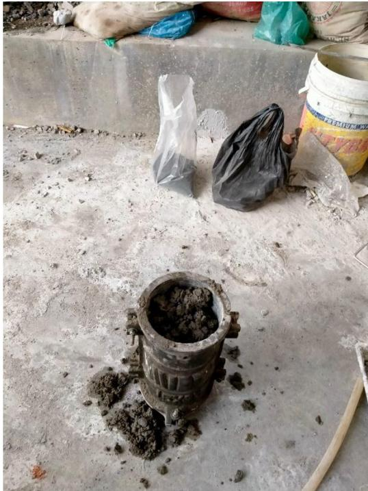
Gambar L. 7 Pembuatan benda uji
