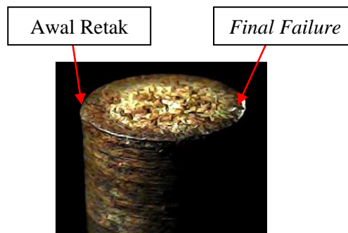
Gambar 4.7 Spesimen uji Baja ST37 pembebanan 5 kg dengan pembesaran 20×
