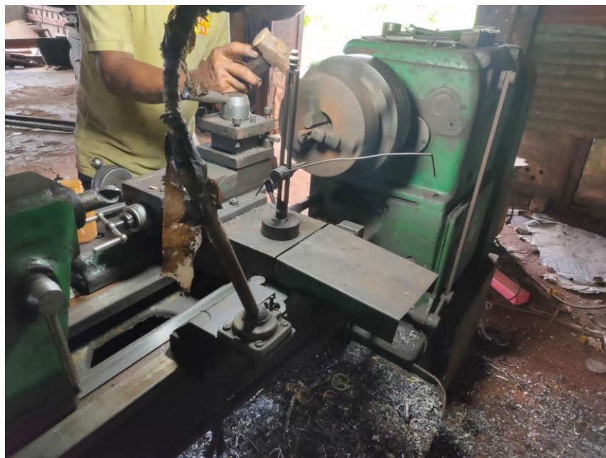
Foto Pembubutan Spesimen Uji Sesuai Dengan ASTM E 606
