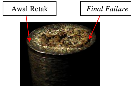
Gambar 4.8 Spesimen uji Baja ST37 pembebanan 10 kg dengan pembesaran 20×
