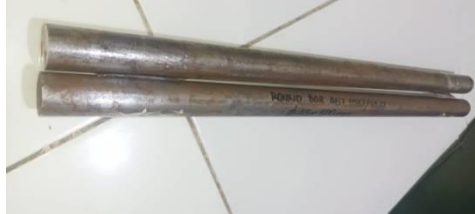
Gambar 3.1 Material uji Baja St 37 tipe Round Bar
