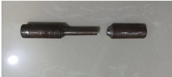
Gambar 4.4. Spesimen Baja ST37 dengan variasi beban 10kg
