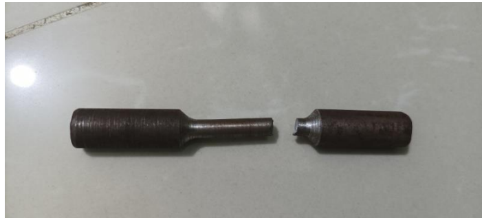
Gambar 4.5. Spesimen Baja ST37 dengan variasi beban 15kg
