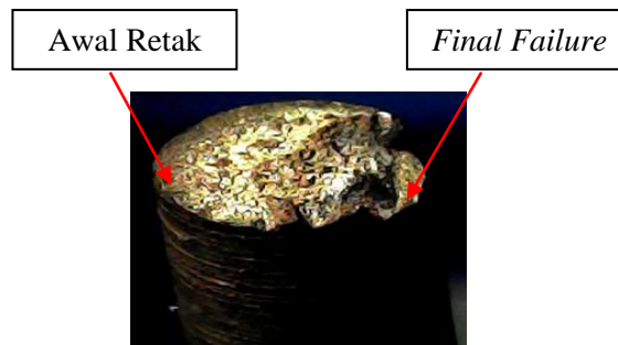
Gambar 4.9 Spesimen uji Baja ST37 pembebanan 15 kg dengan pembesaran 20×
