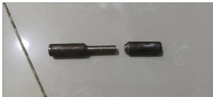
Gambar 4.3. Spesimen Baja ST37 dengan variasi beban 5kg
