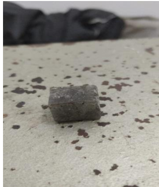
Gambar 4.4 Spesimen 2 Setelah di Uji Tekan
