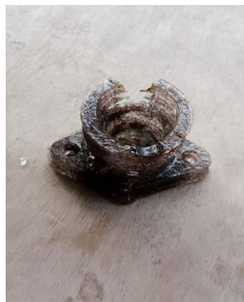
Gambar 4.18 Spesimen 4 Setelah di Uji Termal
