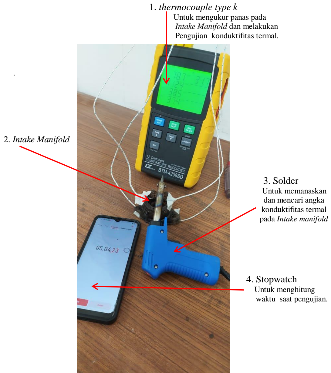
Gambar 3.13 Set Up Alat Uji Konduktifitas Thermal
