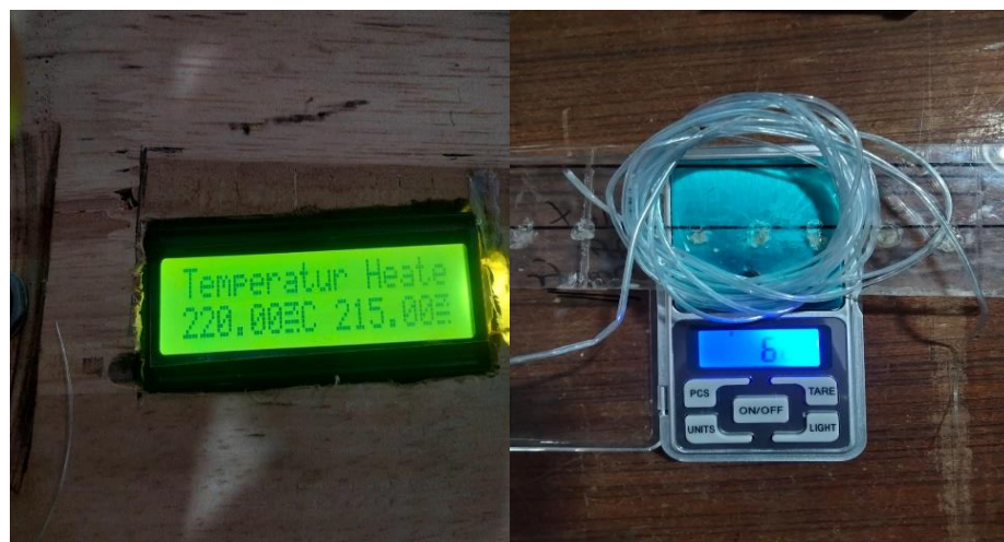
Gambar 4. 24 Filamen 2 Temperatur 220°C
