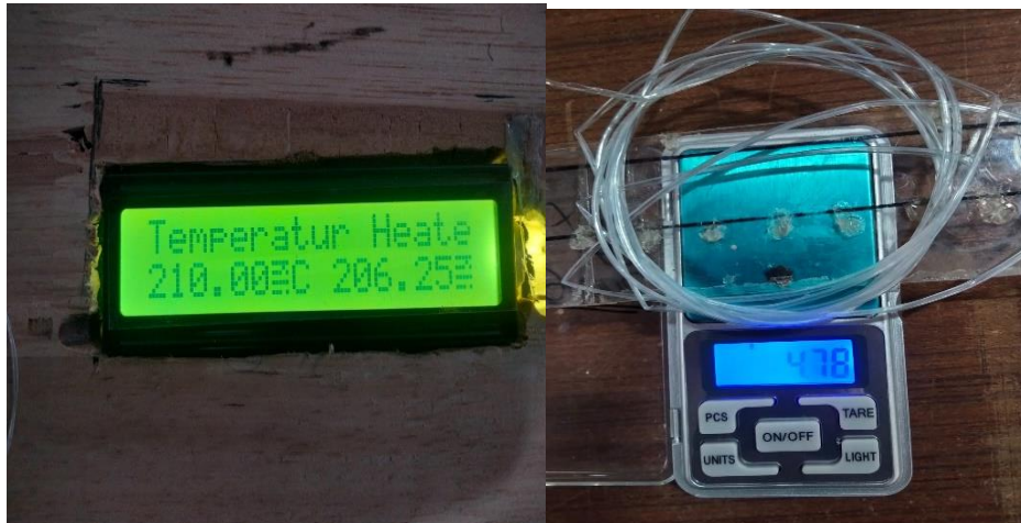
Gambar 4. 23 Filamen 1 Temperatur 210°C
