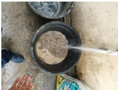
Gambar L. 6 Proses Membersihkan Agregat halus
