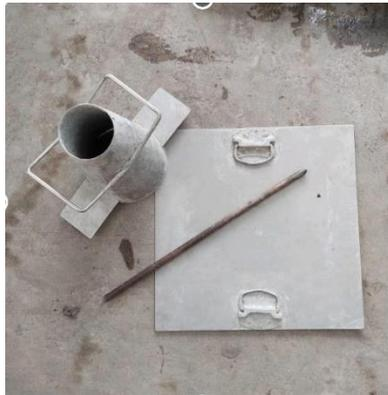
Gambar L. 2 Kerucut Abrams dan tongkat rojok
