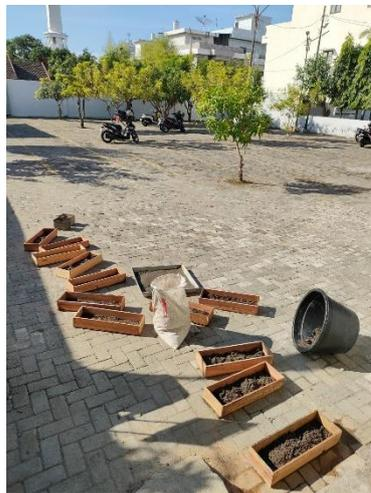
Gambar L. 8 Pengeringan Agregat
