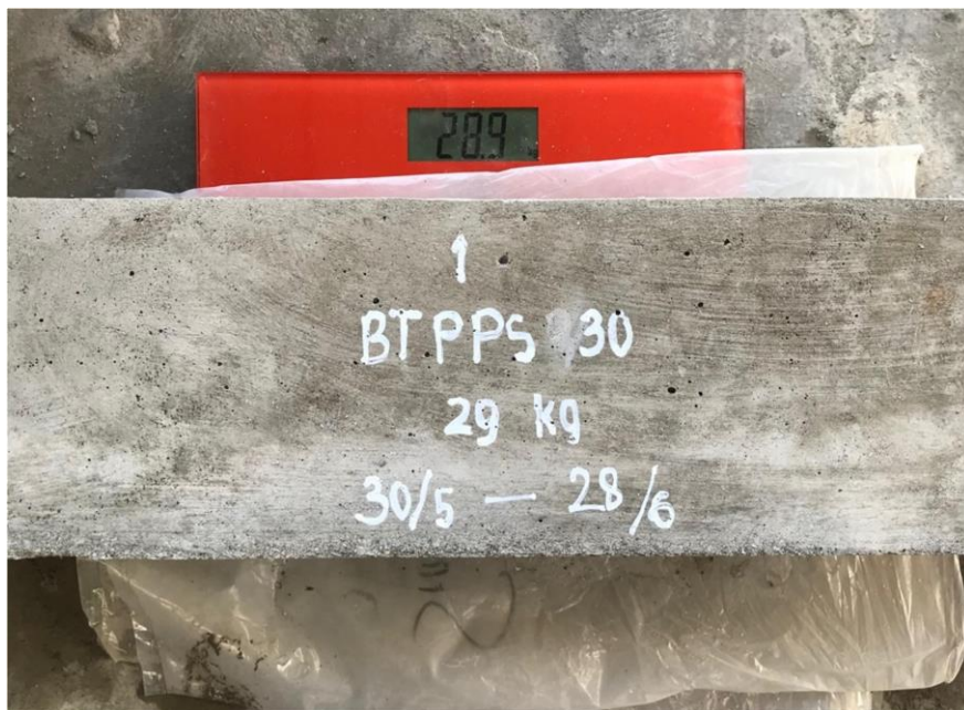
Gambar L.12 : Benda uji balok ditimbang sebelum diuji
