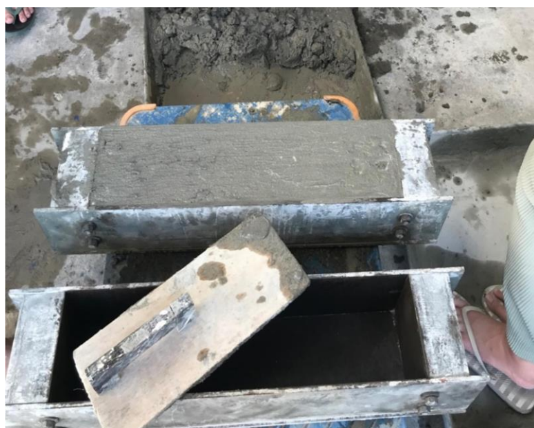
Gambar L.8 : Beton segar dimasukkan ke dalam bekisting
