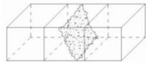
Gambar 2.3 : Balok patah pada 1/3 bentang tengah.
