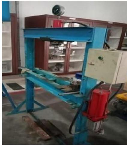
Gambar L8 Mesin Press Hidrolik
