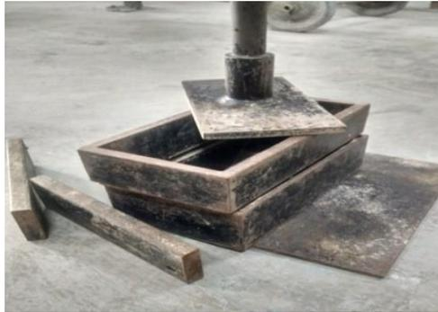
Gambar 3. 9 Alat Cetak Bata
