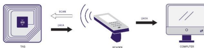
Gambar 2. 11 Sketsa cara kerja RFID
