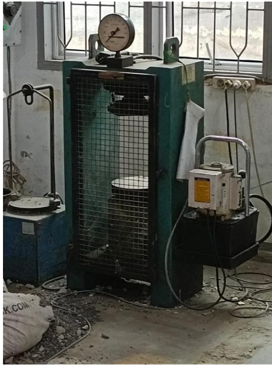
Gambar L9: Uji Tekan Benda Uji Praktikum
