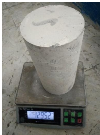
Gambar 3.5: Benda Uji Ditimbang
