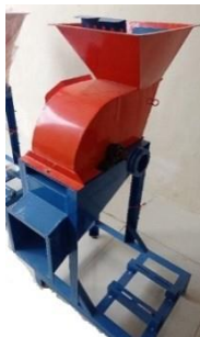
Gambar 2.1 Mesin pencacah rumput gajah (Ratna Dewi, 2021)
