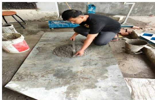
Gambar 3.9 Pengujian Slump Flow
