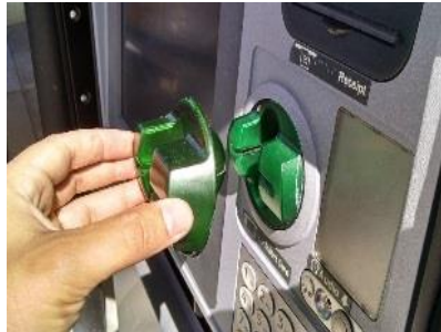
Gambar 1. Proses pemasangan skimmer
