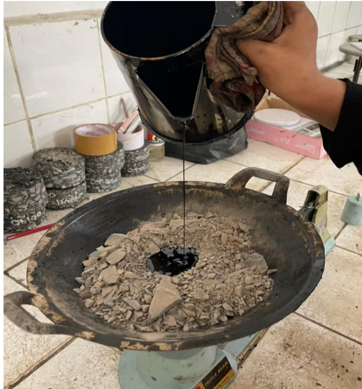
Gambar L11: Proses pencampuran agregat dengan aspal yang telah ditambahkan dengan plastik LDPE
