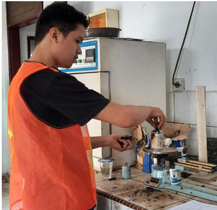
Gambar L10: Proses penimbangan plastik LDPE sesuai kadar variasi.
